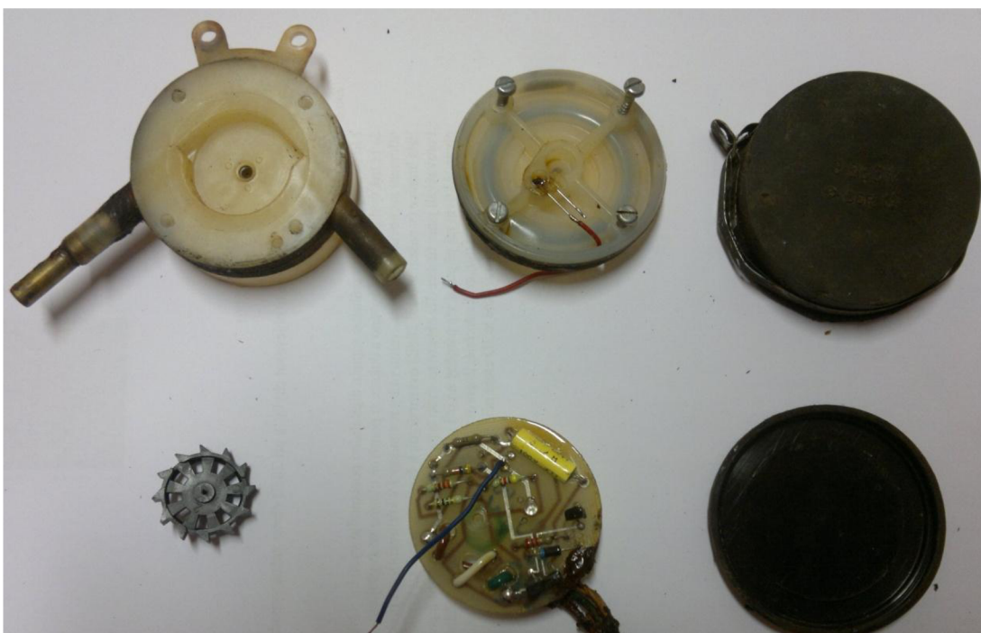
Obrázek 2.5 Demontovaný originální průtokoměr z roku 1985
