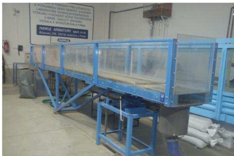
Obr. 5.1 Pohled na sklopný žlab v LVV
