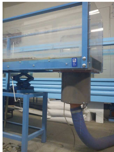
Obr. 5.3 Vyústění potrubí do žlabu
