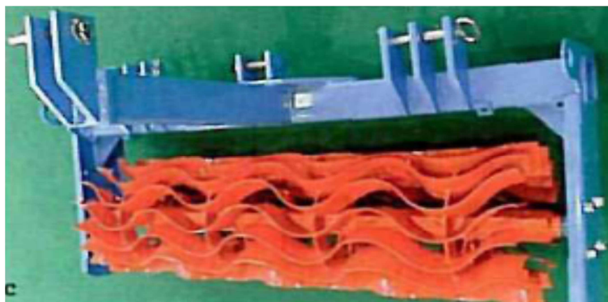
Obr. 11: Válce s přímým, šikmým a vlnitým ostrím (ZEMÁNEK, BURG, Vinařský obzor 2014)
