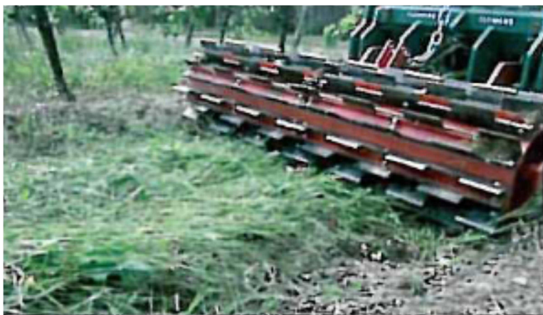
Obr. 10: Stlačené rostliny pro průjezdu mulčovacího válce (ZEMÁNEK, BURG, vinařský obzor 9/2014)
