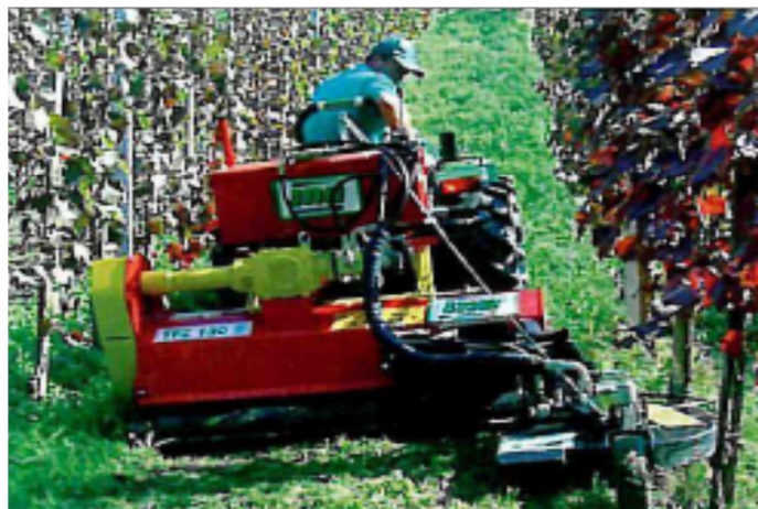
Obr. 9: Mulčovač s výkyvnou sekčí (ZEMÁNEK, BURG, 2010)
