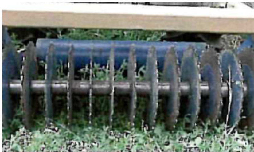
Obr. 13: Mulčovací talířový válec (ZEMÁNEK, BURG, Vinařský obzor 9/2014)
