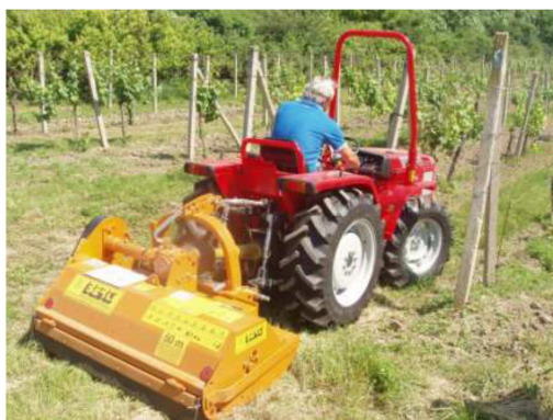
Obr. 8: Mulčovač s horizontální osou rotace (ZEMÁNEK, BURG, 2010)
