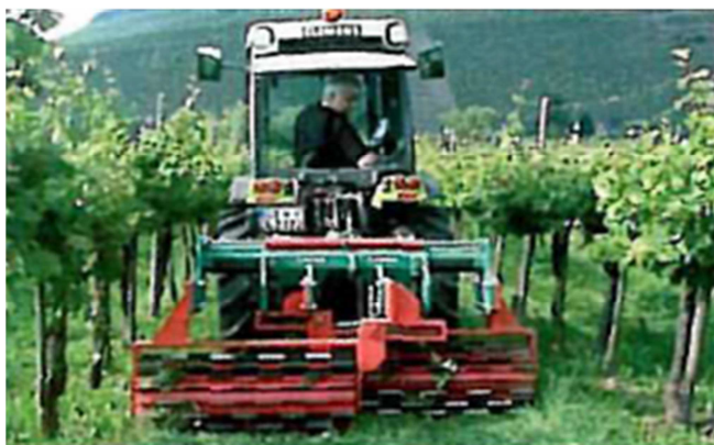
Obr. 12: Dvouválcový mulčovací válec (ZEMÁNEK, BURG, Vinařský obzor 2014)
