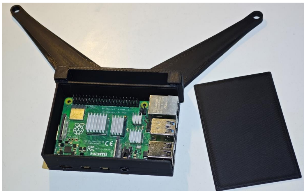
Obrázek 55: Raspberry Pi ve vytištěném šasi
