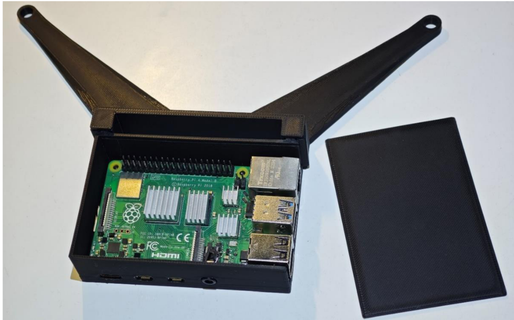
Obrázek 55: Raspberry Pi ve vytištěném šasi
