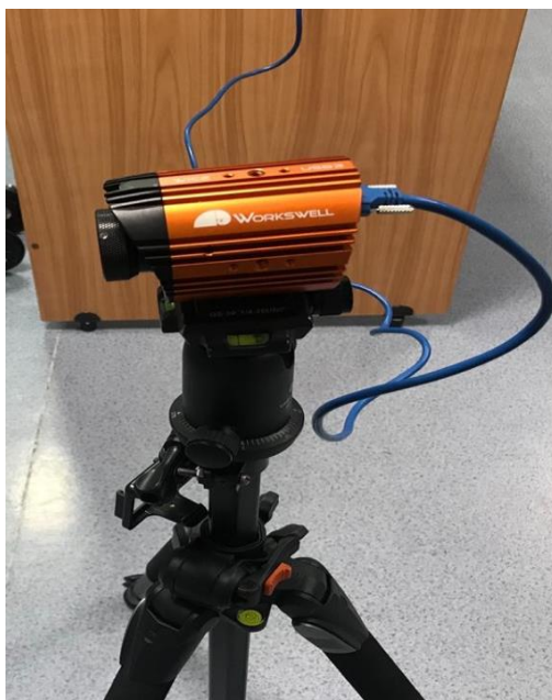
Obrázok 14 Fotografia používanej termokamery WIC 640 na mieste merania
