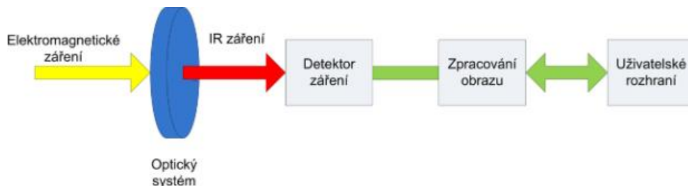
Obrázok 3 Bloková schéma termokamery, prevzaté z [15]
