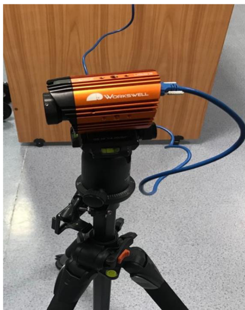
Obrázok 14 Fotografia používanej termokamery WIC 640 na mieste merania
