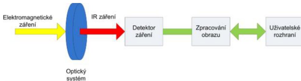
Obrázok 3 Bloková schéma termokamery, prevzaté z [15]
