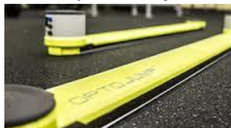
Obrázok č. 6: Detail lišty k meraciemu zariadeniu Optojump Next ( http://www.optojump.com/ )
