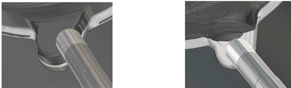
Obrázek 31 Porovnání množství odebíraného materiálu pro dokončení hrubování kruhového vybrání.
