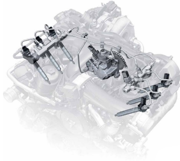
Obr. 18 Palivový systém zabudovaný v motoru 3,0 l V6 TDI 2. generace [18]
