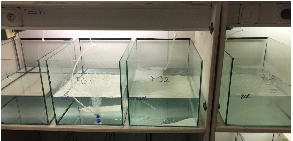
Obrázek č. 5: Jedna skupina 20 l akvárií v laboratorní místnosti připravená na vysazení ryb. Lze si všimnout výrazného zakalení v pokusné skupině Fenbendazolu (FB), který je ve vodě špatně rozpustný a vytváří v ní zvláštní strukturu (foto autor).
