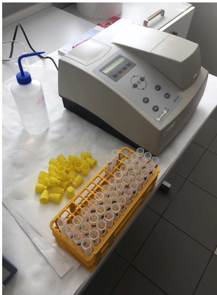
Obrázek č. 11: Připravené vzorky na měření ve spektrofotometru při vlnové délce 540nm. (foto autor).
