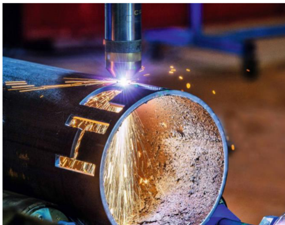
Obr. 4 Detailní řezání plazmou [8]
