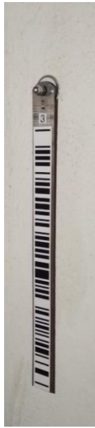
Obrázok 4.8 Závesná stupnica umiestnená na monitorovanom bode
