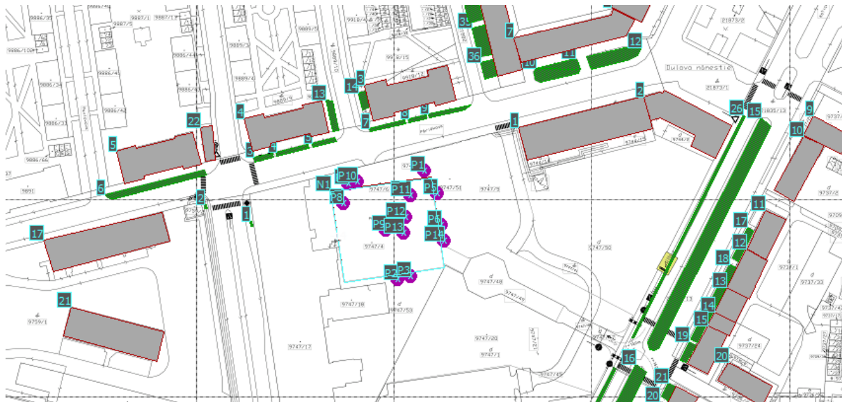
Obrázok 141: Umiestnenie zdrojov hluku na stavenisku [software HLUK+]
