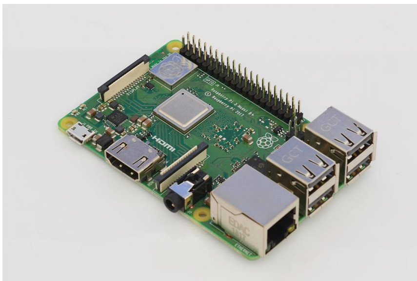
Obrázek 1 - Počítač Raspberry Pi 3 model B+ (vlastní zpracování)
