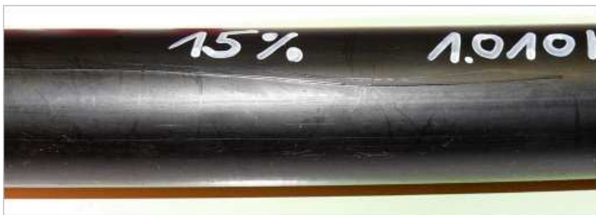
Obr. 18 – Výsledek vrypové zkoušky potrubí z materiálu PE-RC : k destrukci nedošlo ani po 1 010 hodinách, pak bylo testování ukončeno, aniž došlo na vrypu ke změnám [8].
