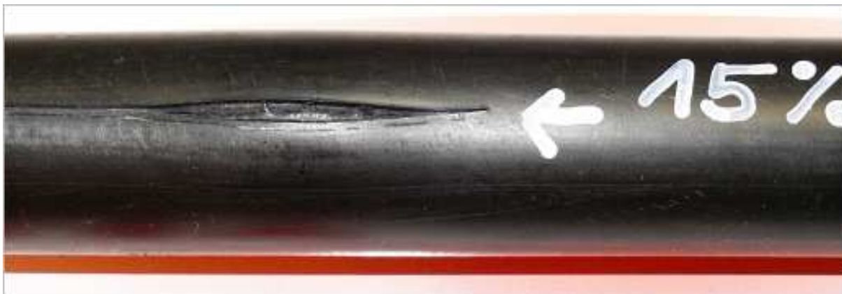
Obr. 17 – Výsledek vrypové zkoušky potrubí z materiálu PE 100 Hard Structure : k destrukci došlo po 57,2 hodinách [8].
