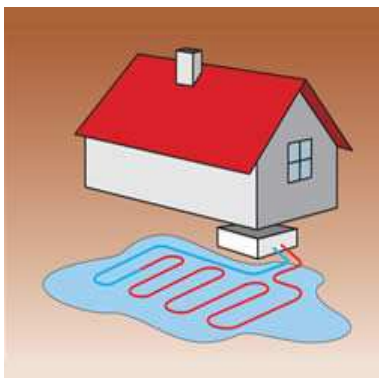
Obr. 8 – TČ využívající povrchovou vodu [9]
