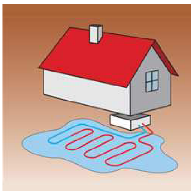
Obr. 8 – TČ využívající povrchovou vodu [9]
