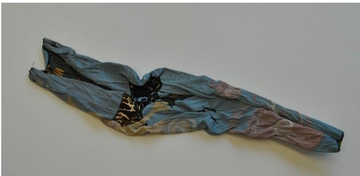
Obrázek 6 - PVC etiketa po tepelné expozici
