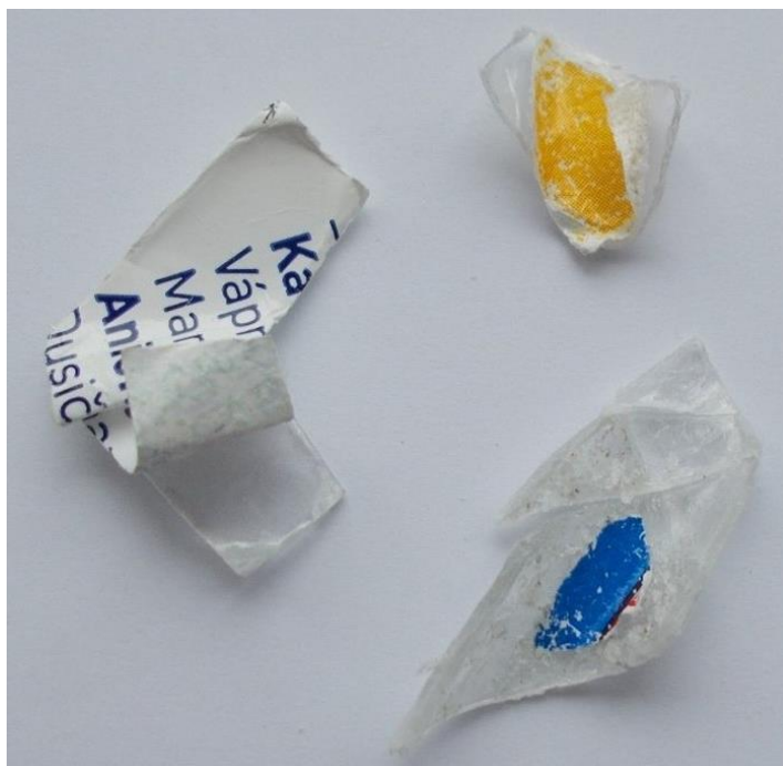
Obrázek 10 - PET vločky s kontaminací etiketou/lepidlem
