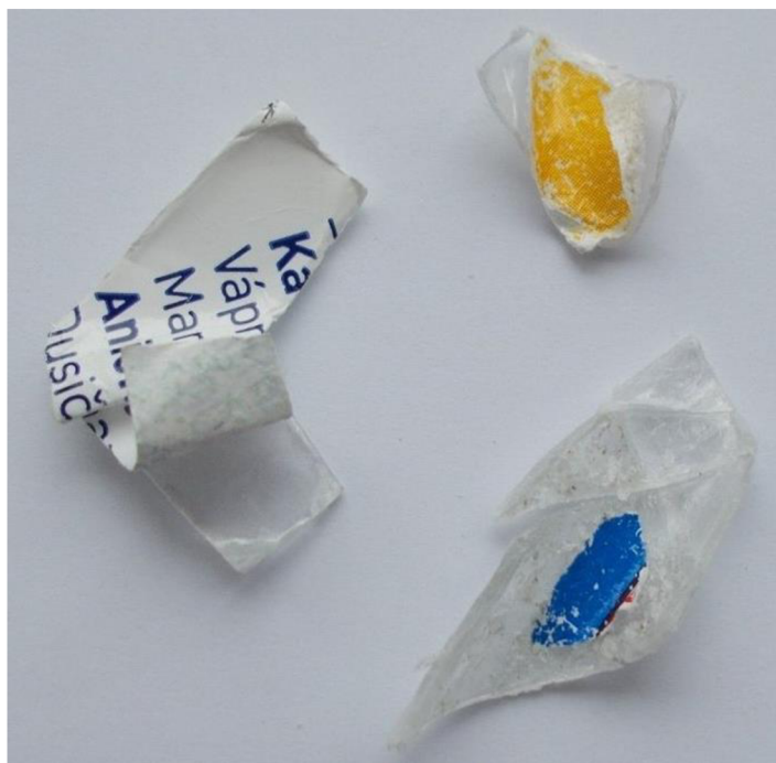
Obrázek 10 - PET vločky s kontaminací etiketou/lepidlem
