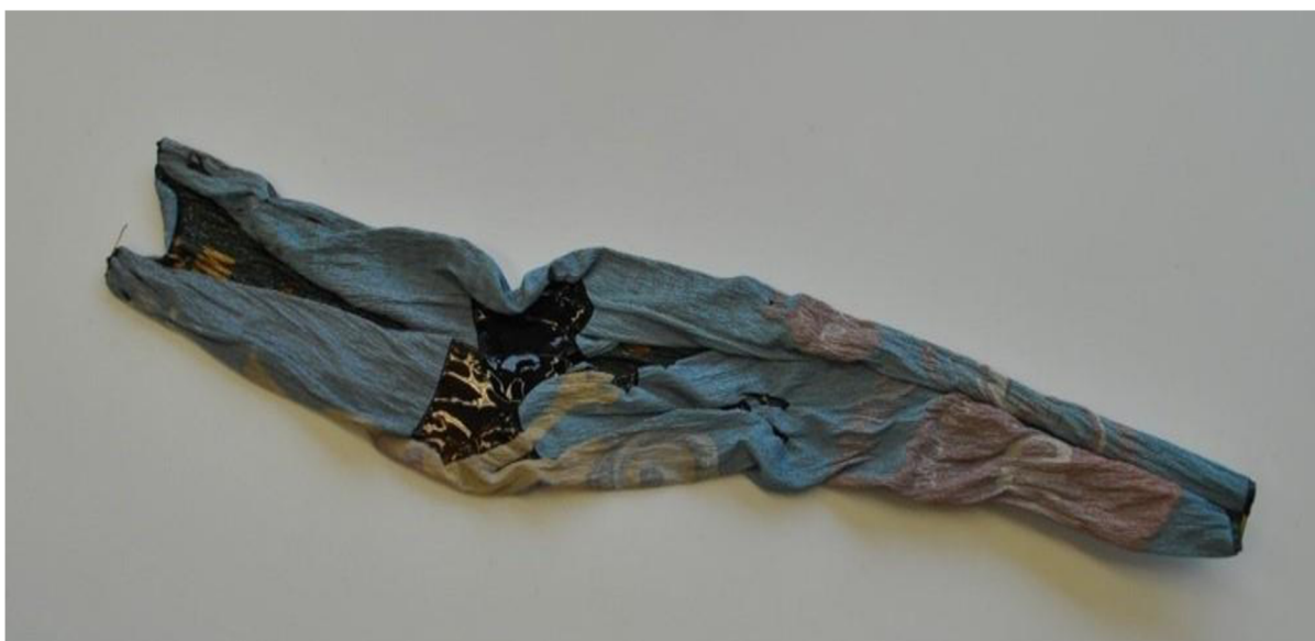
Obrázek 6 - PVC etiketa po tepelné expozici
