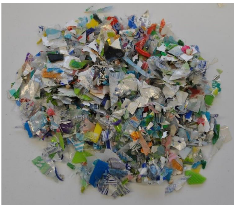
Obrázek 5 – Polyolefiny – směs PE a PP vzniklá při recyklaci PET lahví
