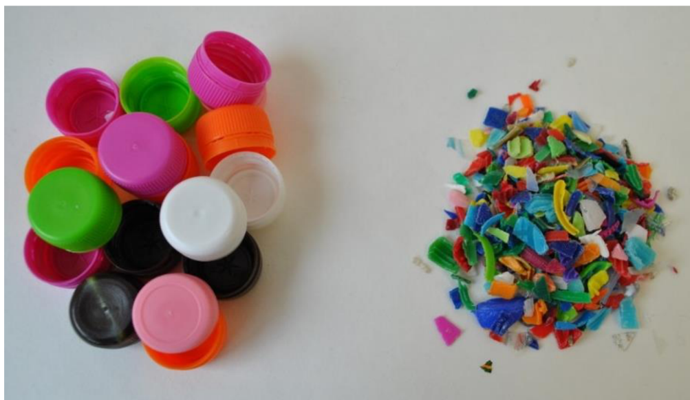
Obrázek 4 - vlevo: HDPE víčka PET lahví, vpravo: HDPE drť po recyklaci PET připravená na znovupoužití
