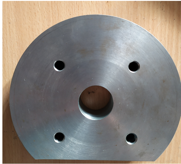
Obrázek 5.1: Modifikovaná stahovací deska pro zkoušku čtyřbodovým ohybem
