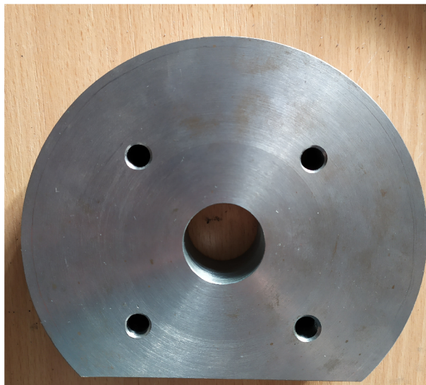
Obrázek 5.1: Modifikovaná stahovací deska pro zkoušku čtyřbodovým ohybem
