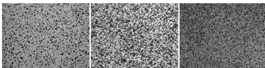
Obr. 2.4: Stochastický vzor vhodný pro měření metodou DIC, převzato z [9]
