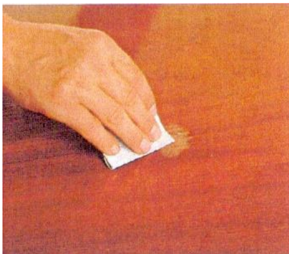
Obrázek 16 - Vyhlazení dřeva po vyrovnání prohlubně [Cook, 2005]
