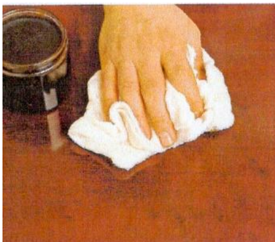
Obrázek 23 - Leštění voskové povrchové úpravy [Cook, 2005]
