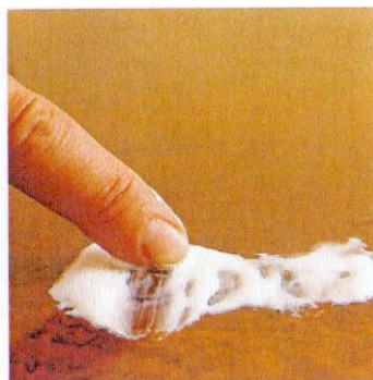
Obrázek 4 - Aplikace lepidla [Cook, 2005]
