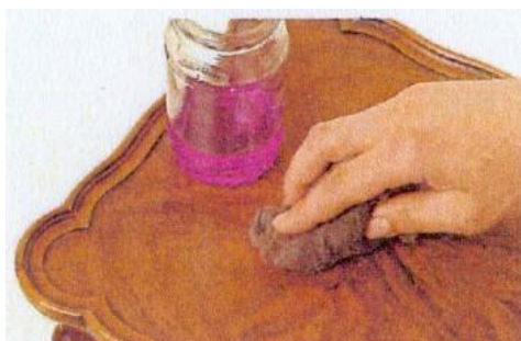
Obrázek 9 - Odstranění poškozené politury [Cook, 2005]
