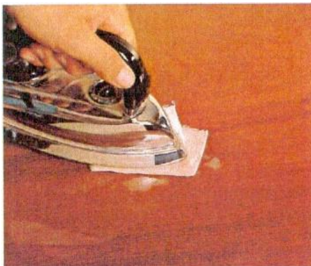
Obrázek 14 - Vyrovnání prohlubně pomocí žehličky [Cook, 2005]
