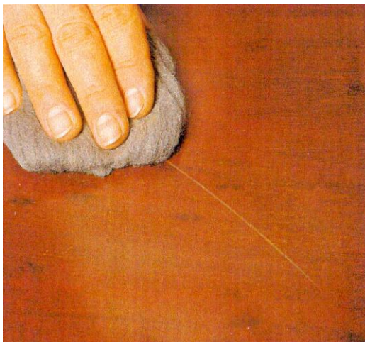
Obrázek 20 - Odstranění vosku kolem škrábance [Cook, 2005]
