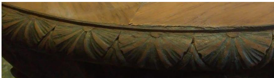
Obrázek 27 - Poškozená dýha na stolové desce [vlastní fotografie]
