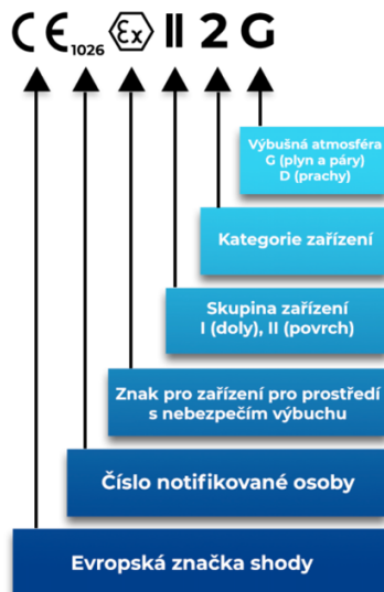
Obr. 3) Označování elektrických zařízení do prostředí s nebezpečím výbuchu pro plyny a páry [21]
