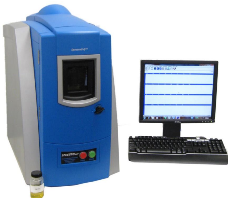
Obrázek 12: Atomový emisní spektrometr Spectroil Q100 (Spectro.cz, 2014)
