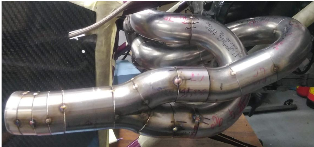
Obrázek 23 – Boční pohled na potrubí připravené ke svaření [Zdroj: Autor]
