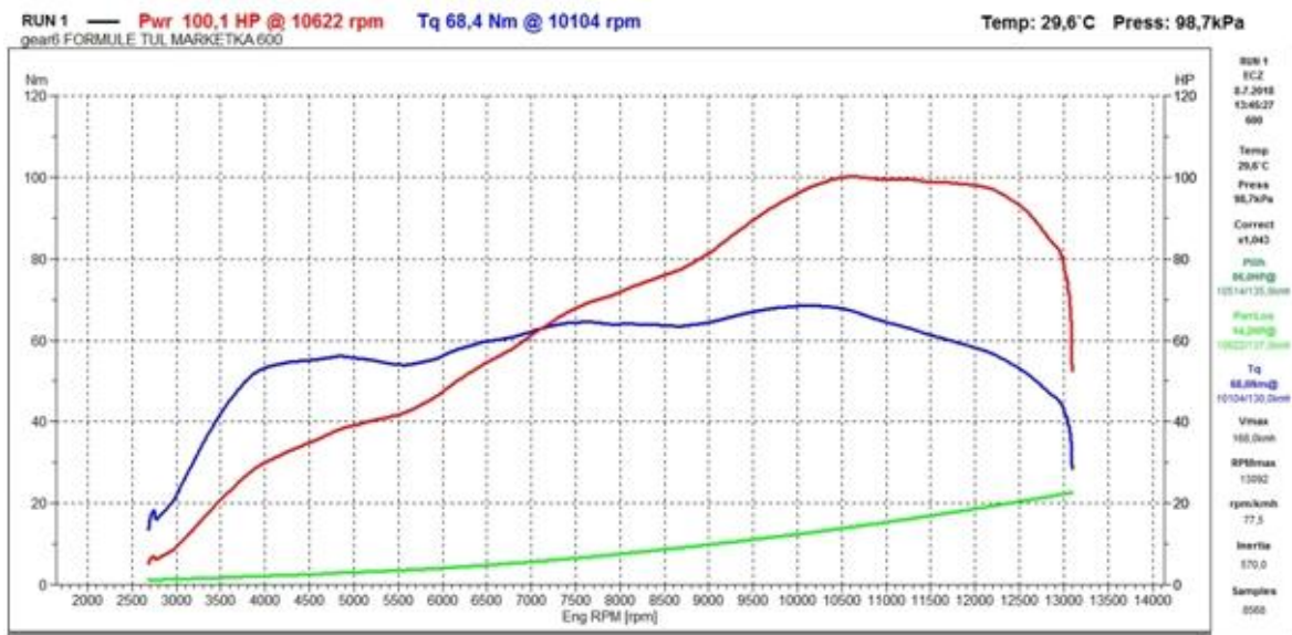
Obrázek 26 - Graf momentového průběhu aktuálního monopostu [Zdroj: Autor]
