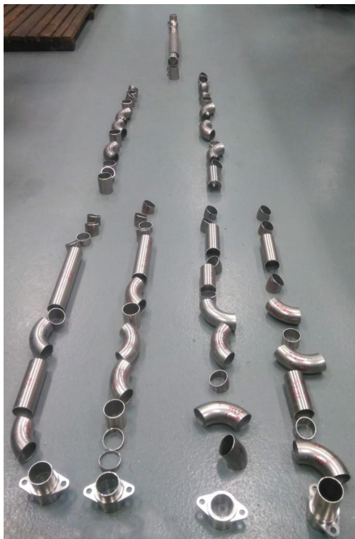
Obrázek 21 - Díly potrubí připravené ke svaření [Zdroj: Autor]
