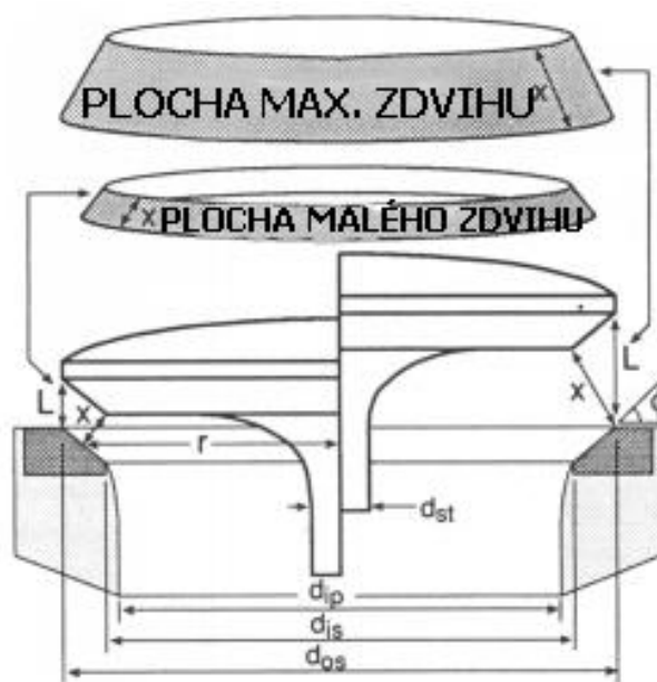
Obrázek 14 – Schéma ventilu při zdvihu[9]
