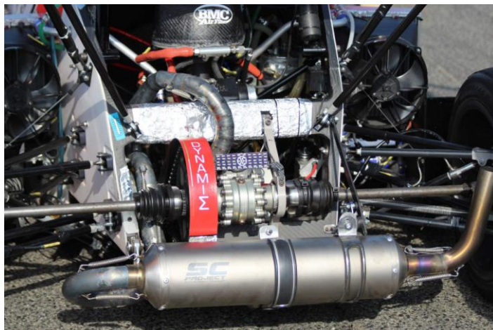
Obrázek 9 - Uspořádání vzadu za diferenciálem[Zdroj: Autor]
