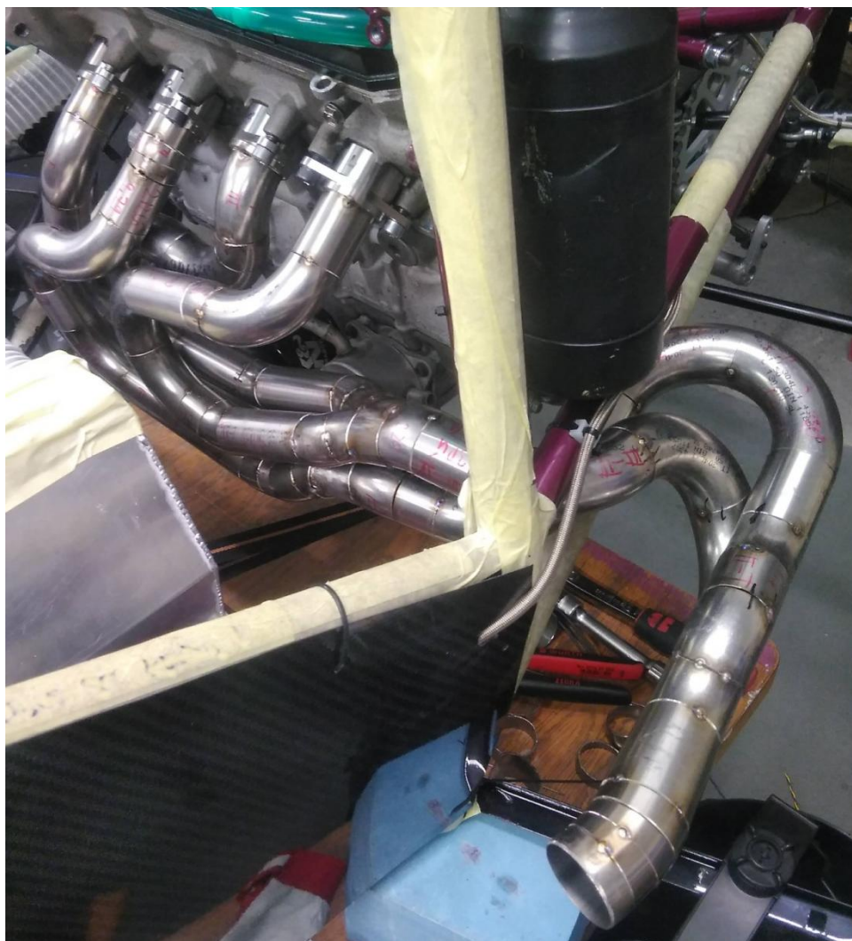
Obrázek 22 - Sběrné potrubí připravené ke svaření[Zdroj: Autor]
