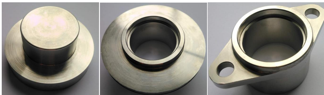
Obrázek 20 – Postup výroby upevňovací příruby [Zdroj: Autor]
