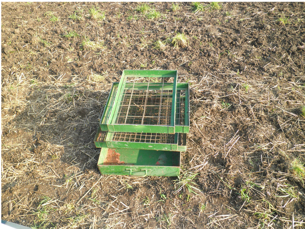
Obr. 11: Síta pro stanovení velikostních frakcí hroud.
