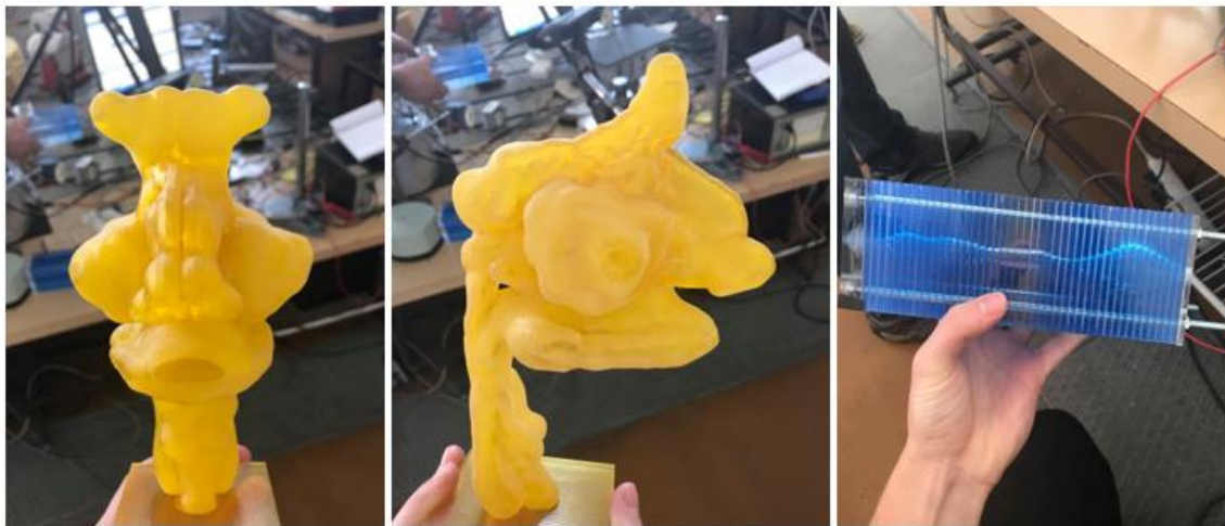
Obrázek 14: Podrobná napodobenina rezonančních dutin vokálního traktu (vlevo a uprostřed) a zjednodušený model vokálního traktu (vpravo)
