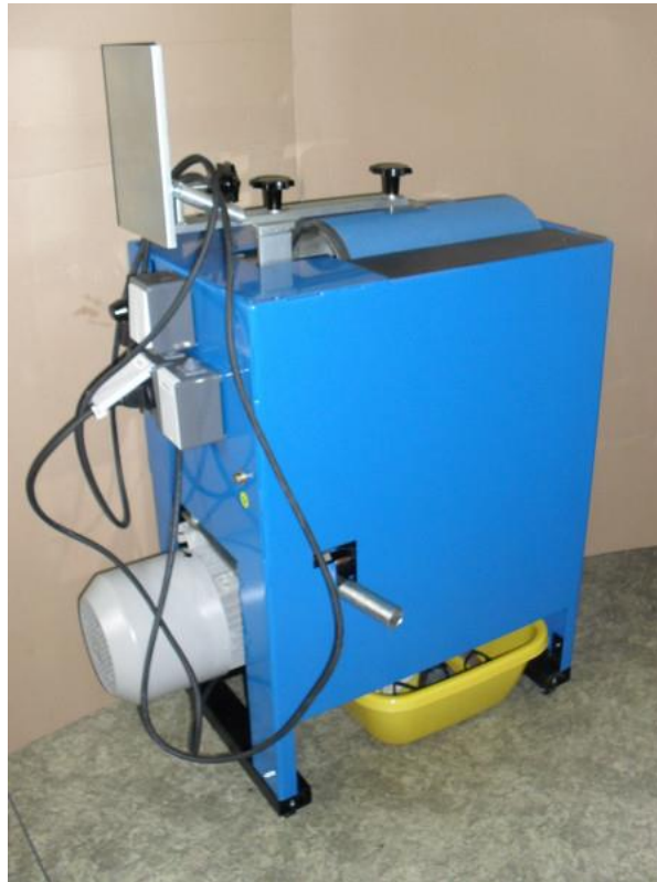
Obrázek č.1: Brouška pro broušení lyží a snowboardů BRS 350
