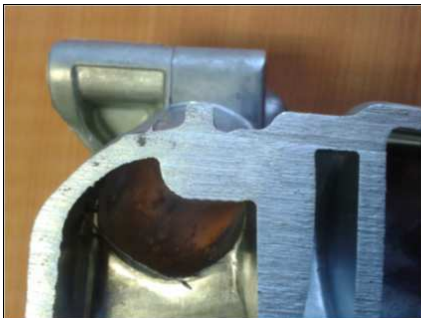
Obr. 46 Původní tvar vnitřní části ovlivňující porezitu
