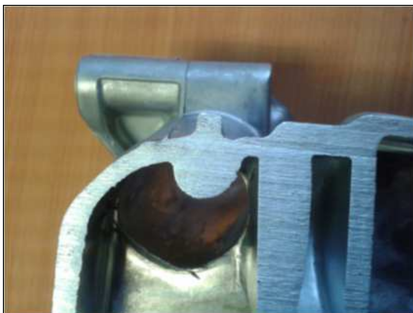
Obr. 47 Upravený tvar vnitřní části ovlivňující porezitu
