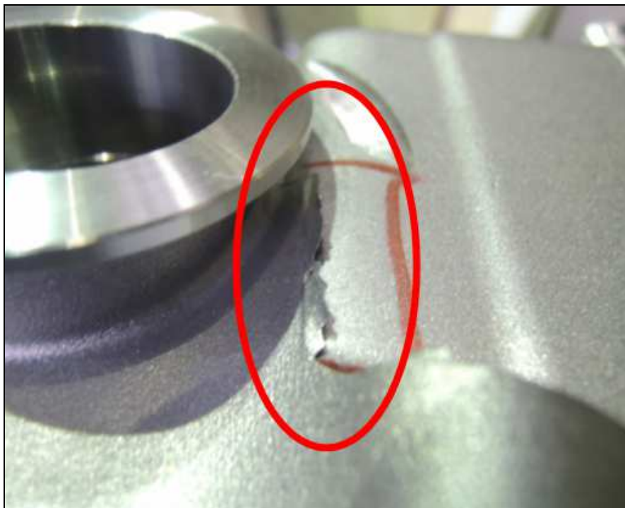
Obr. V6 Neopilovaná část odlitku
