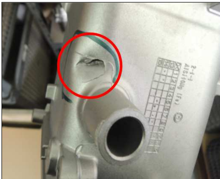
Obr. V3 Prasklina na těle odlitku
