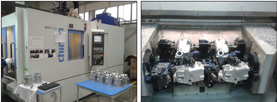
Obr. 35 Obráběcí centrum a detail upnutí odlitků
