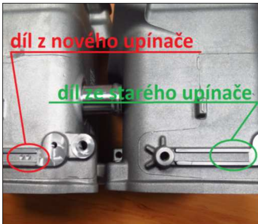
Obr. V9 Vada způsobená starým upínačem
