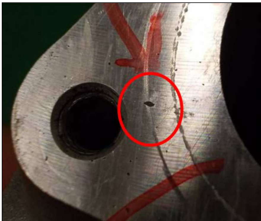
Obr. V11 Porezita odhalená po obrábění
