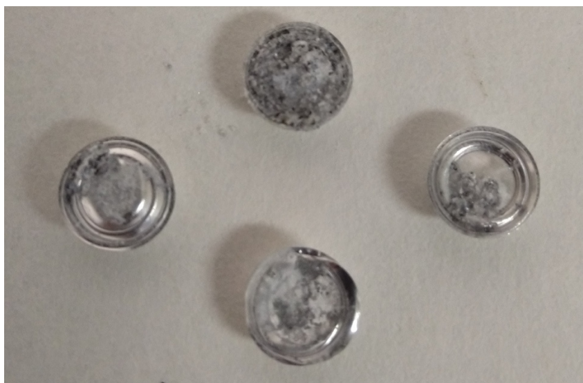
Obrázek 26: Pánvičky SP24E, které podlely korozi
