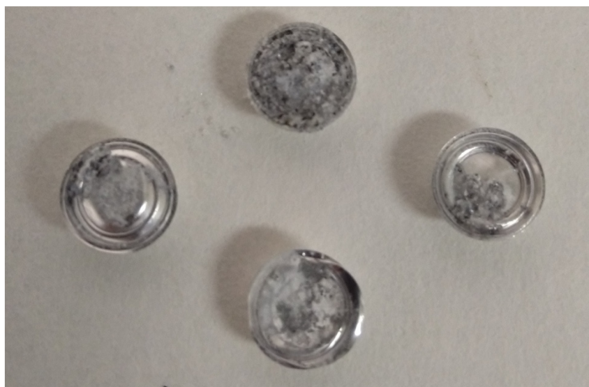
Obrázek 26: Pánvičky SP24E, které podlely korozi
