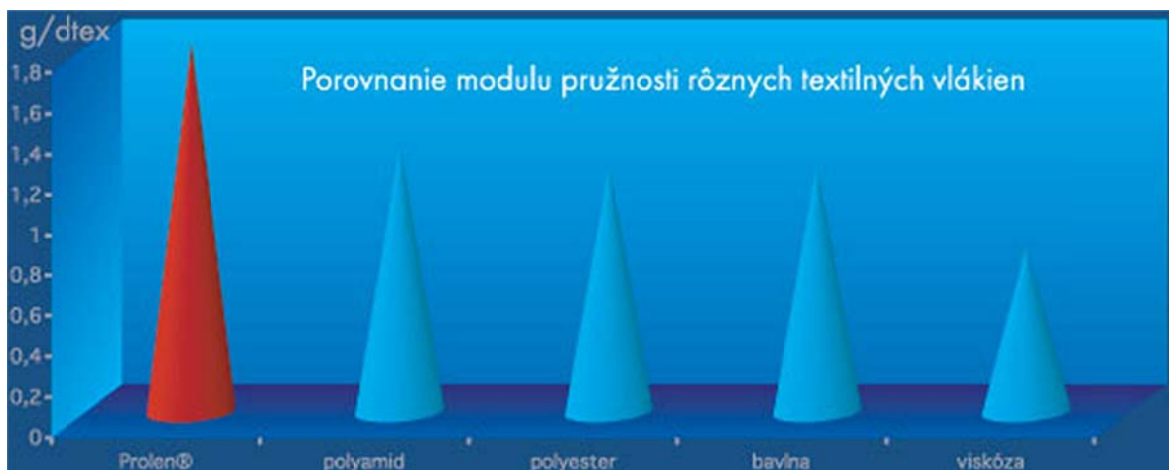
Obrázok 8: Porovnanie modulu pružnosti rôznych typov textilných vlákien (5).
