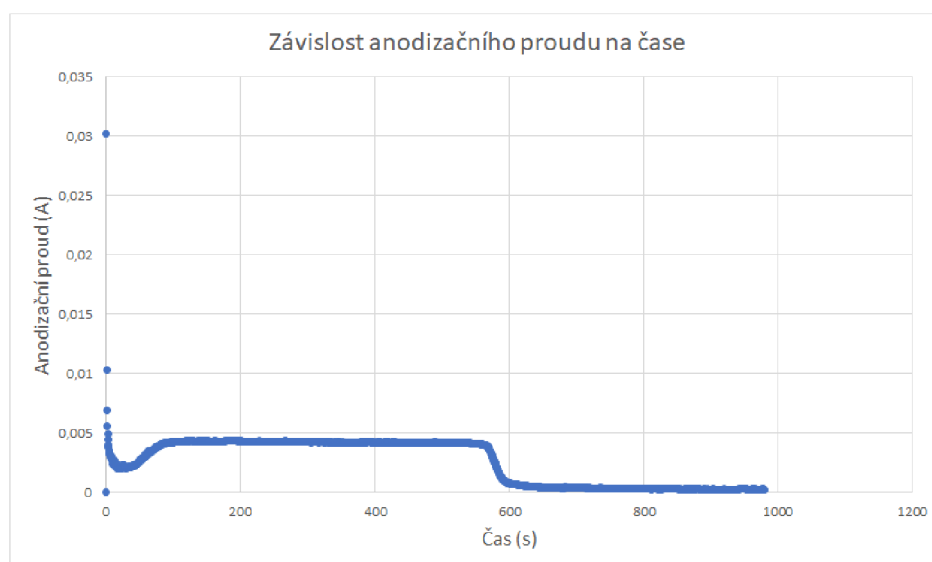
Obrázek 4.3: Průběh anodizačního proudu v čase. Anodizace waferu při 40 V.
