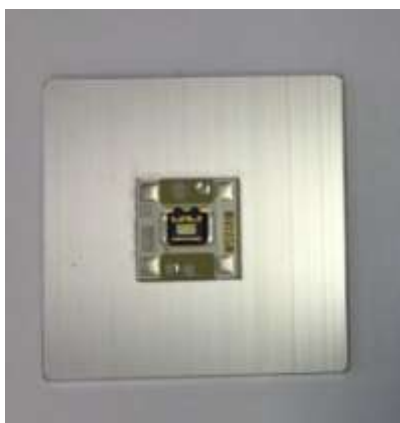
Obrázek 16 - Umístění LED čipu na vzorek
