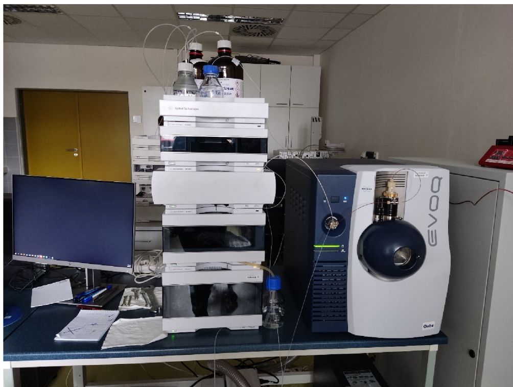
Obrázek 17: Použitý kapalinový chromatograf Agilent 1290 Infinity s hmotnostním spektrometrem Bruker EVOQ LC-TQ
