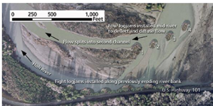
Obrázek 8: Letecký snímek vyobrazující funkci říčních struktur v řece Hoh (Hall et Moler 2006).
