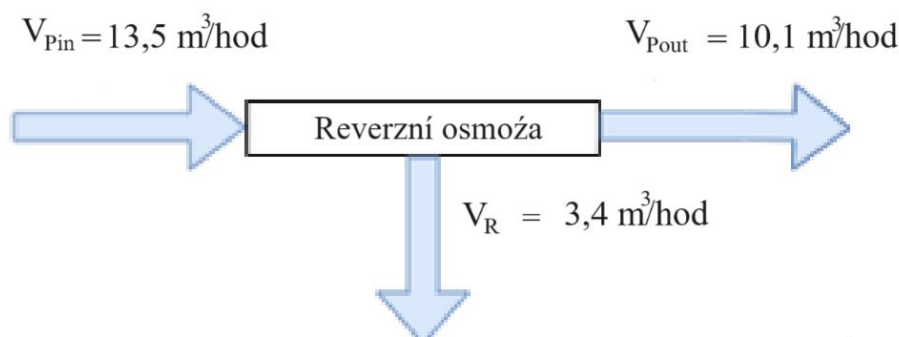
Obr. 15 Schéma recyklačního kroku reverzní osmózy koncepčního návrhu recyklační linky
