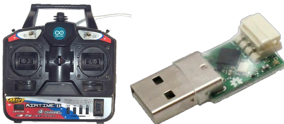
Obr. 16: Vlastná ovládačka a obvod pre komunikáciu
