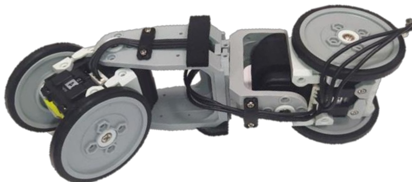
Obr. 36: Kardanový kĺb vytvorený zo sady Bioloid
