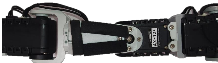
Obr. 54: Detail na penové podložky zospodu
