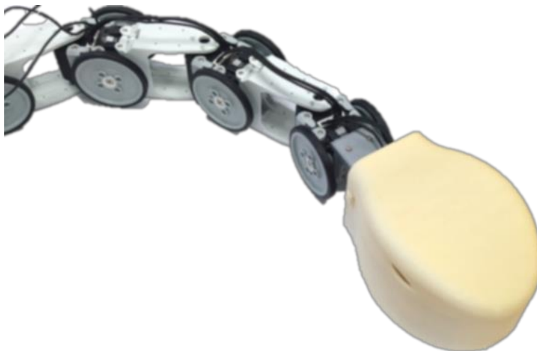
Obr. 58: Detail konštrukcie planárneho robotického hada
