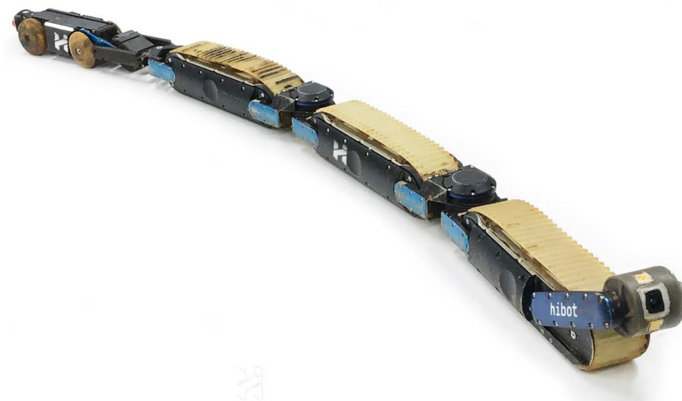
Obr. 14: Robot pre kontrolu kanalizácie, Soryu-C [11]
