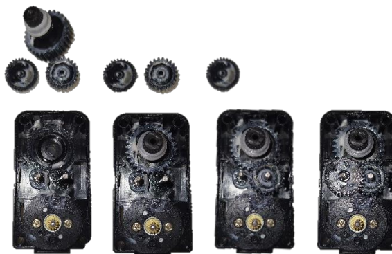
Obr. 20: Prevodovka aktuátora AX-12
