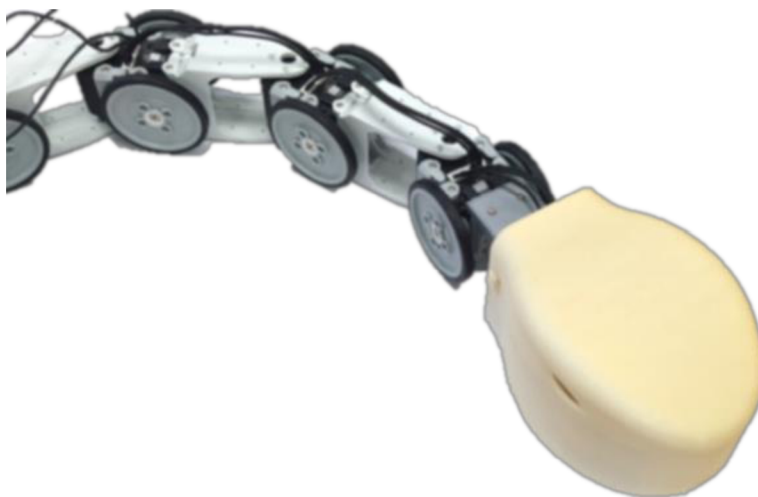
Obr. 58: Detail konštrukcie planárneho robotického hada
