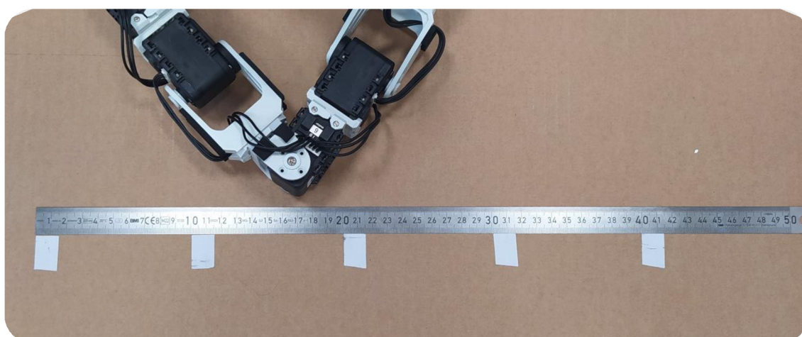
Obr. 51: Značky na testovacej rovine, rozteč 10 mm
