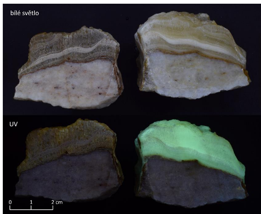
Obr. 51 Vzorek z lomu Smrčnick podrobený termické zkoušce. Po zahřátí na 300 °C (snímek vlevo) je jasně vidět ztráta luminiscence a změna barvy speleotém ve srovnání s nezařítvanou polovinou vzorku vpravo.
