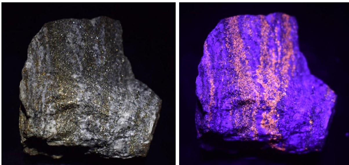
Obr. 14 Sfalerit z ložiska Zlaté Hory–východ ve viditelném světle (vlevo) a v UV světle (vpravo).
