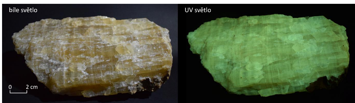
Obr. 38 Hrubě krystalický speleotémový kalcit štěpící se podél kontaktních krystalických ploch v bílém světle (vlevo) a UV světle (vpravo).
