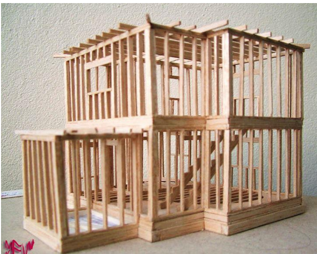
Obr. 7 (dole) Model konstrukčního systému Platform-Frame (4DZ, 2007)
