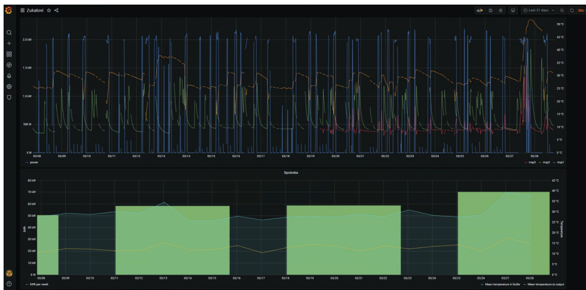
Obrázek 5.5: Snímek obrazovky z webové aplikace Grafana, která umožňuje přehledné zobrazování dat z databáze pomocí grafů a ukazatelů. Je možné provádět agregaci nad vybranými daty nebo zobrazovat data za zvolené časové období.
