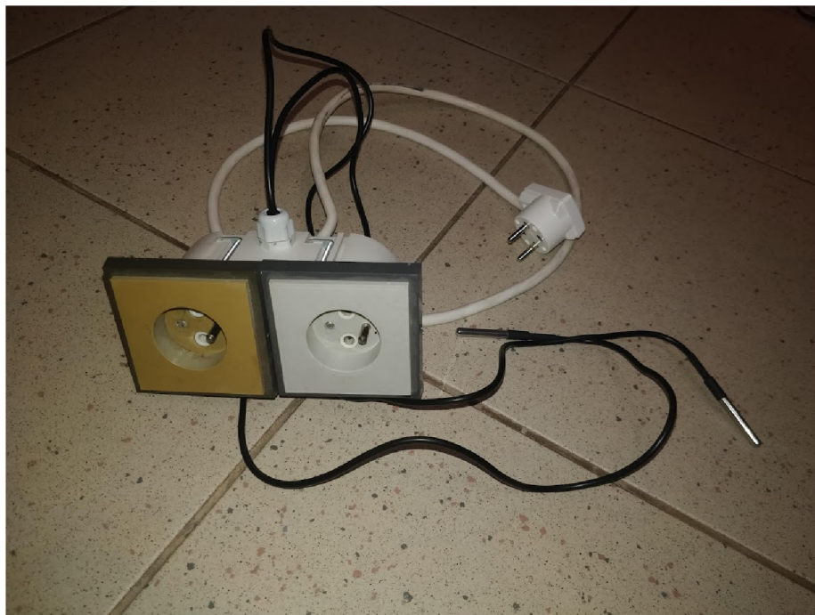
Obrázek 5.2: Výsledné zařízení pro sběr dat z bojleru a řízení ohřevu v podobě flexibilního přívodu elektrické energie, který obsahuje chytré relé Shelly 1PM ukryté za zásuvkou pro připojení napájení bojleru, které slouží pro spínání bojleru. Kromě toho kabel disponuje dvěma teplotními čidly DS18B20 pro měření teploty na bojleru.
