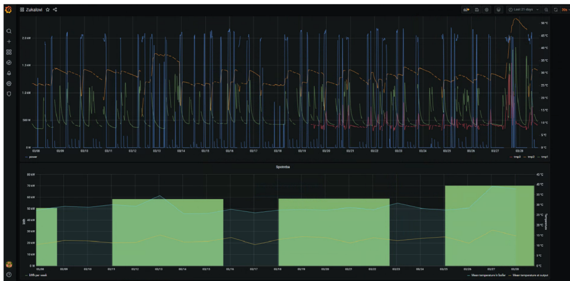
Obrázek 5.5: Snímek obrazovky z webové aplikace Grafana, která umožňuje přehledné zobrazení dat z databáze pomocí grafů a ukazatelů. Je možné provádět agregaci nad vybranými daty nebo zobrazovat data za zvolené časové období.
