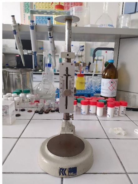
Obrázek 12: Vicatův přístroj (Foto autor)
