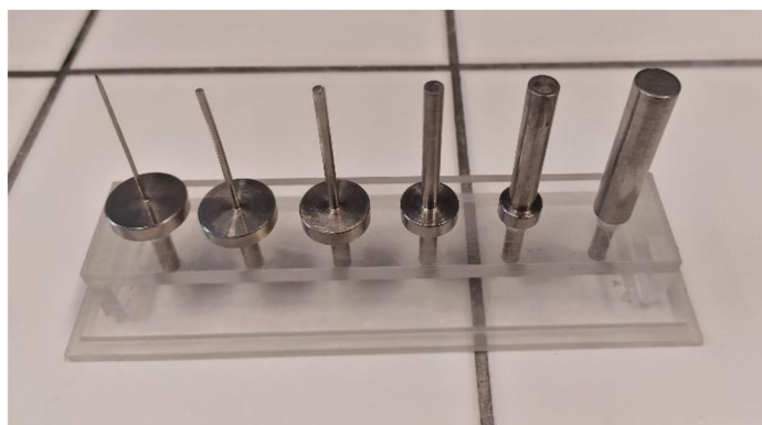
Obrázek 21: Nástavce pro měření Vicatovým přístrojem (jehla a různé druhy válečků) (Foto autor)
