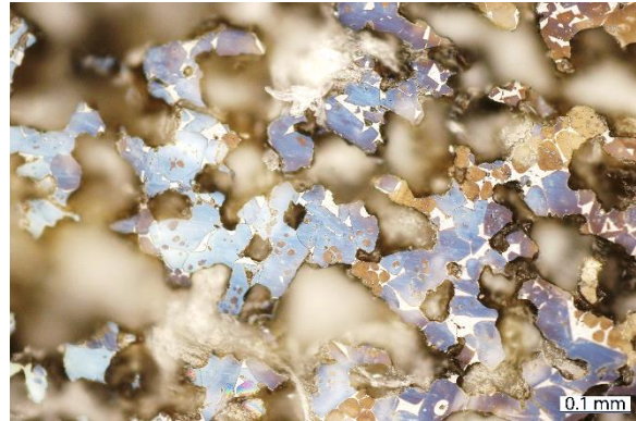
Obr. 33 Slínek 2S, modré krystaly – alit, hnědá – belit, světlé plošky mezi zrny – mezerní hmota, černé difúzní oblasti – otevřené póry
