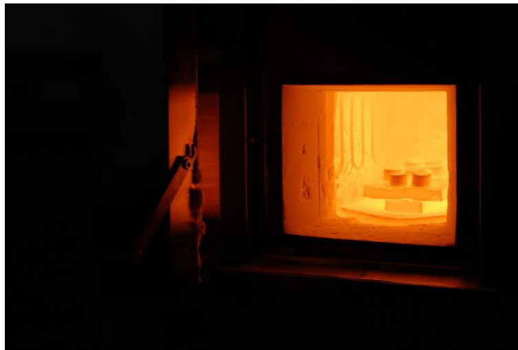
Obr. 10 Superkantolová pec s vylisovanými slínkovými tabletami
