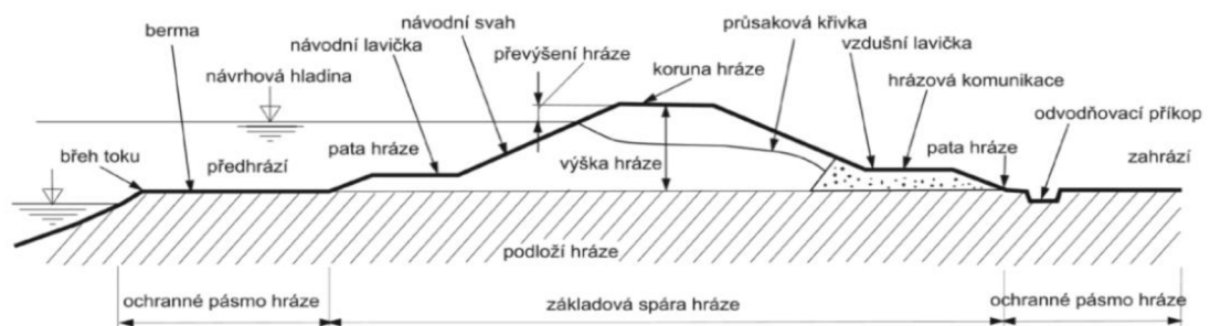
Obrázek 12: Schéma ochranné hráze Zdroj: (Říha, 2010)
