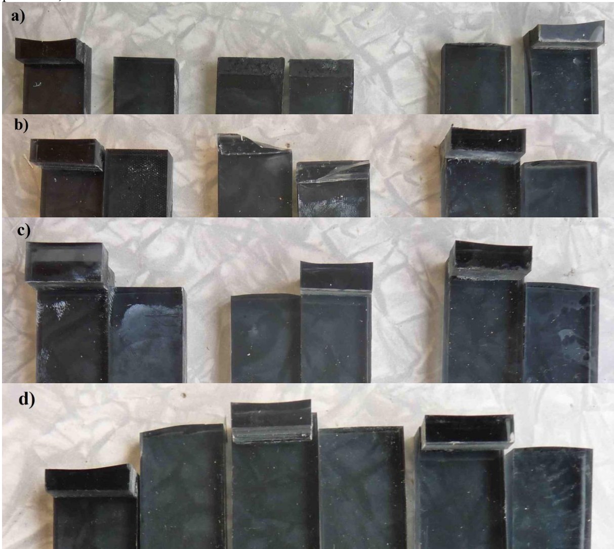
a) Loctite 480 b) Loctite 406 c) Sika Lock 2020 PR d) Sika Lock 2300 RT B První a druhá dvojice nechána pokojové teplotě, třetí dvojice vložena do kataplasmy Obr. 58 Polykarbonát
