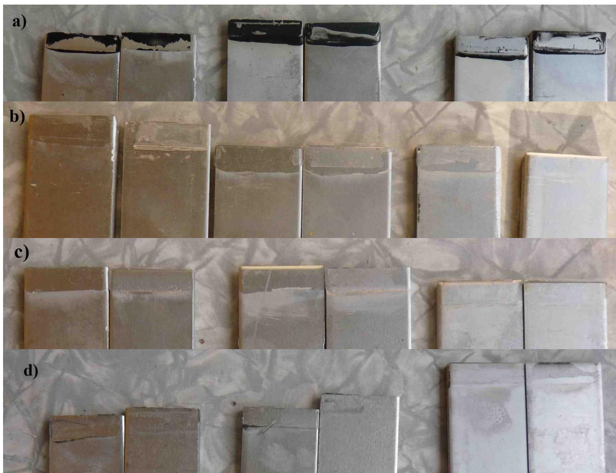
a) Loctite 480 b) Loctite 406 c) Sika Lock 2020 PR d) Sika Lock 2300 RT B První a druhá dvojice nechána pokojové teplotě, třetí dvojice vložena do kataplasmy Obr. 40 Hliník
