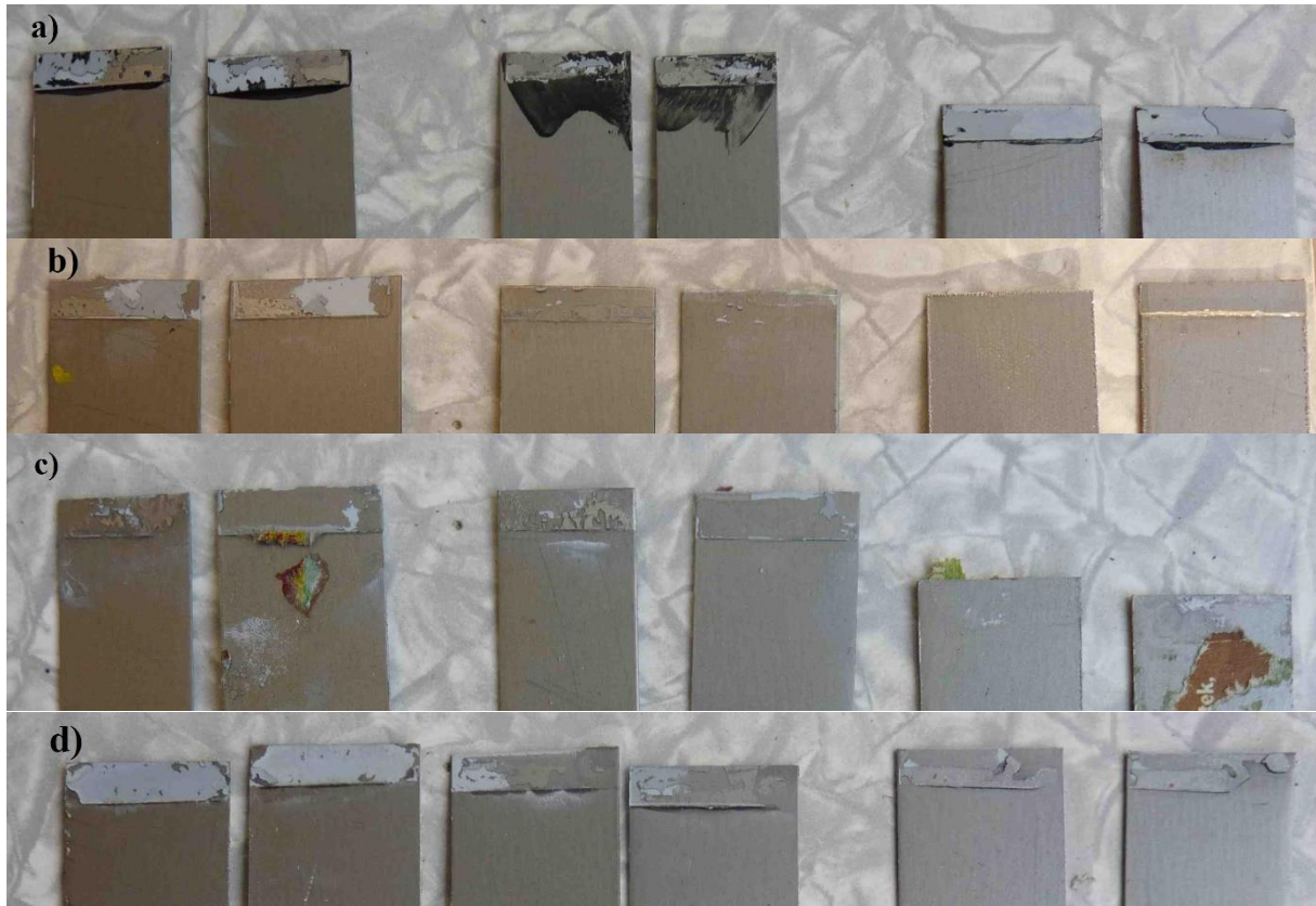
a) Loctite 480 b) Loctite 406 c) Sika Lock 2020 PR d) Sika Lock 2300 RT B První a druhá dvojice nechána pokojové teplotě, třetí dvojice vložena do kataplasmy Obr. 46 Ocelový plech S254 s povlakem práškového laku
