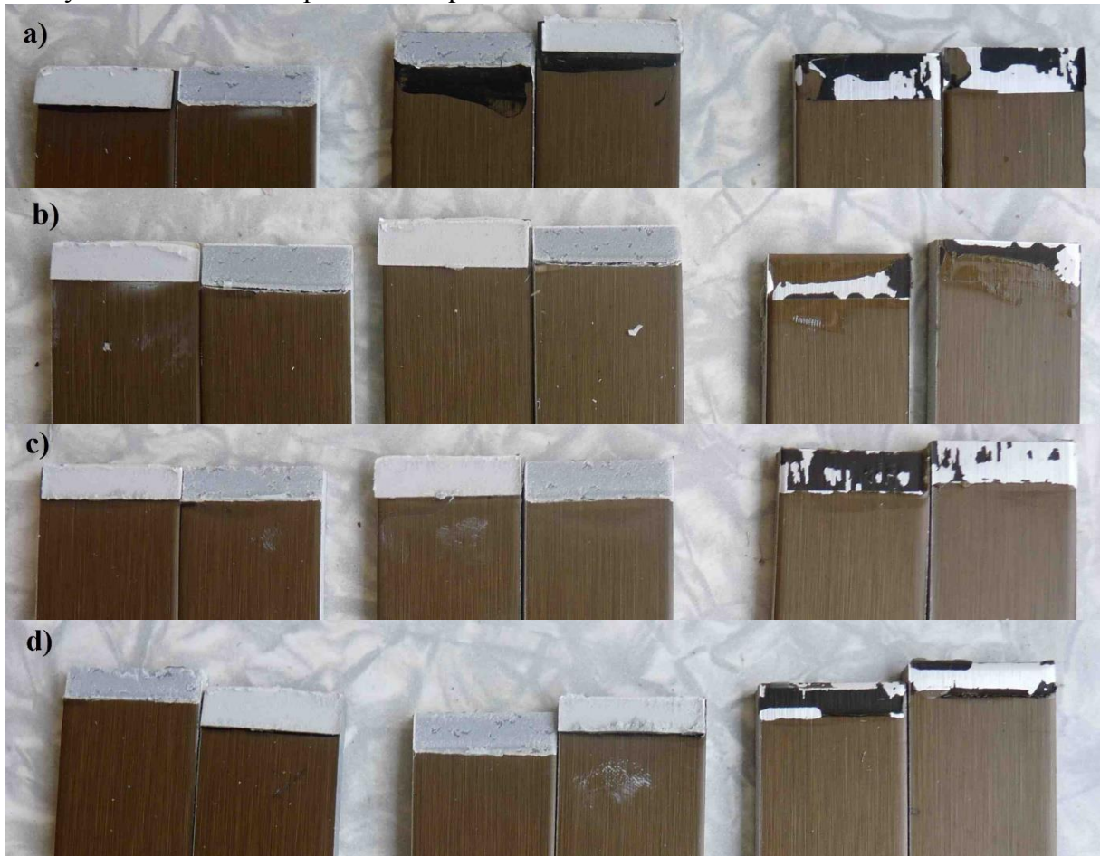
a) Loctite 480 b) Loctite 406 c) Sika Lock 2020 PR d) Sika Lock 2300 RT B První a druhá dvojice nechána pokojové teplotě, třetí dvojice vložena do kataplasmy Obr. 43 Hliník s eloxovanou vrstvou
