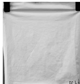
Obr. 12 Mokrý a suchý vzorek materiálu s úpravou Easy Care po 25. cyklu údržby
