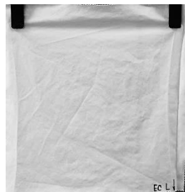
Obr. 12 Mokrý a suchý vzorek materiálu s úpravou Easy Care po 25. cyklu údržby
