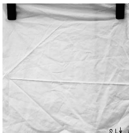
Obr. 13 Mokrý a suchý vzorek materiálu s úpravou Soft po 5. cyklu údržby
