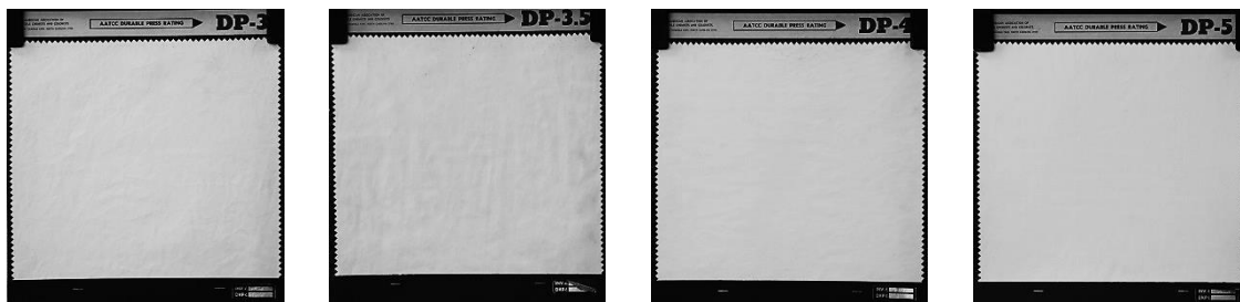
Obr. B1 Trojrozměrné etalony se stupni DP-3, DP-3,5, DP-4 a DP-5
