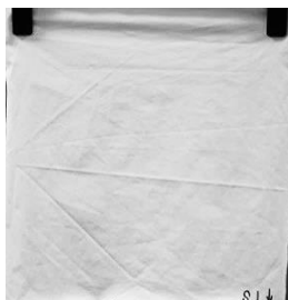
Obr. 13 Mokrý a suchý vzorek materiálu s úpravou Soft po 5. cyklu údržby
