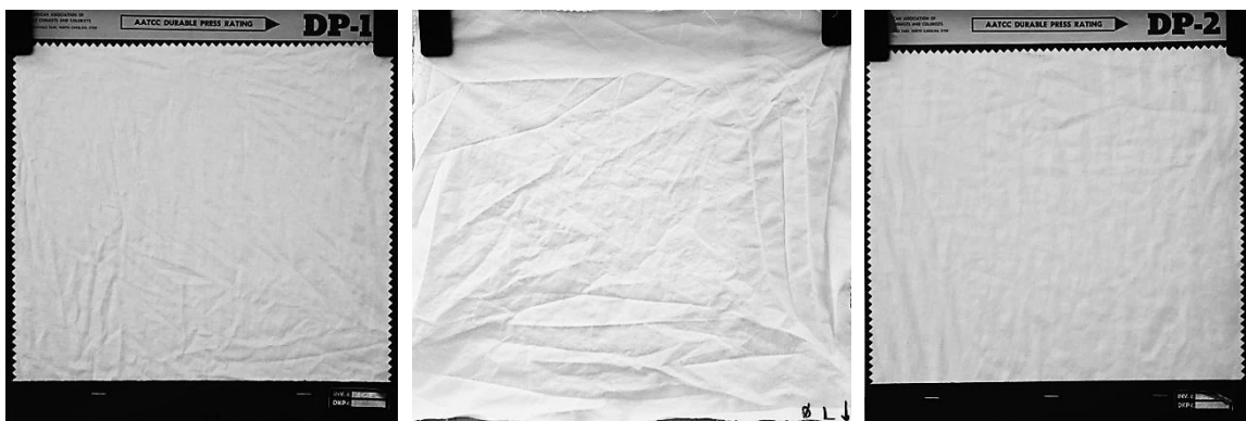
Obr. 5 Porovnání mokrého vzorku materiálu bez finální úpravy s trojrozměrnými etalony se stupněm pomačkání DP-1 a DP-2 po 5. cyklu údržby
