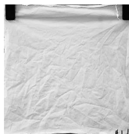
Obr. 16 Mokrý a suchý vzorek materiálu bez finální úpravy po 25. cyklu údržby
