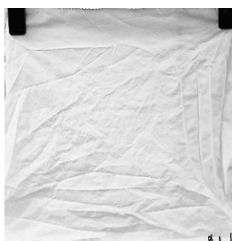
Obr. 15 Mokrý a suchý vzorek materiálu bez finální úpravy po 5. cyklu údržby
