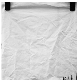
Obr. 11 Mokrý a suchý vzorek materiálu s úpravou Easy Care po 5. cyklu údržby
