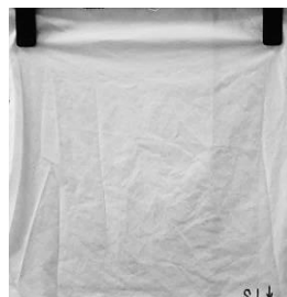
Obr. 14 Mokrý a suchý vzorek materiálu s úpravou Soft po 25. cyklu údržby
