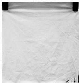
Obr. 11 Mokrý a suchý vzorek materiálu s úpravou Easy Care po 5. cyklu údržby
