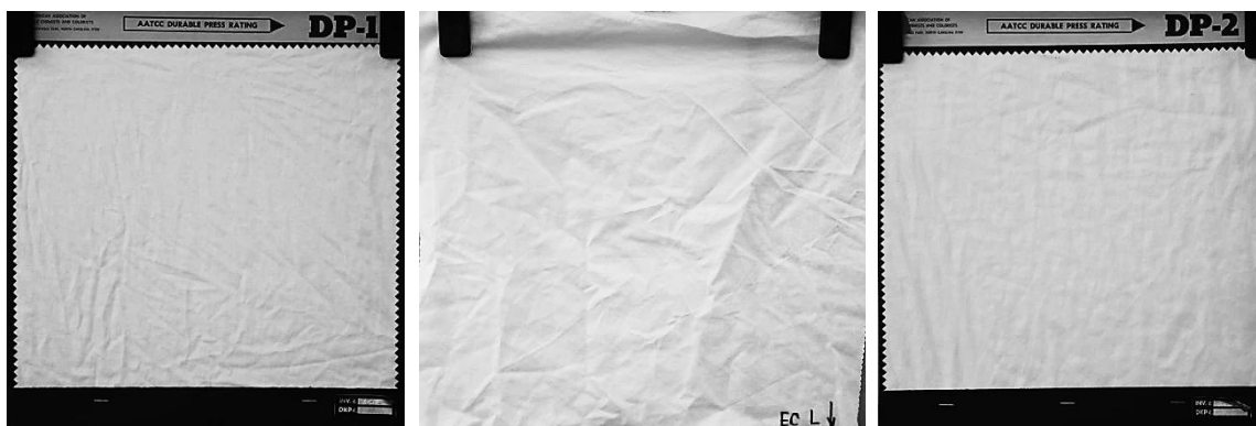
Obr. 6 Porovnání mokrého vzorku materiálu opatřeného úpravou Easy Care s trojrozměrnými etalony se stupněm pomačkání DP-1 a DP-2 po 5. cyklu údržby
