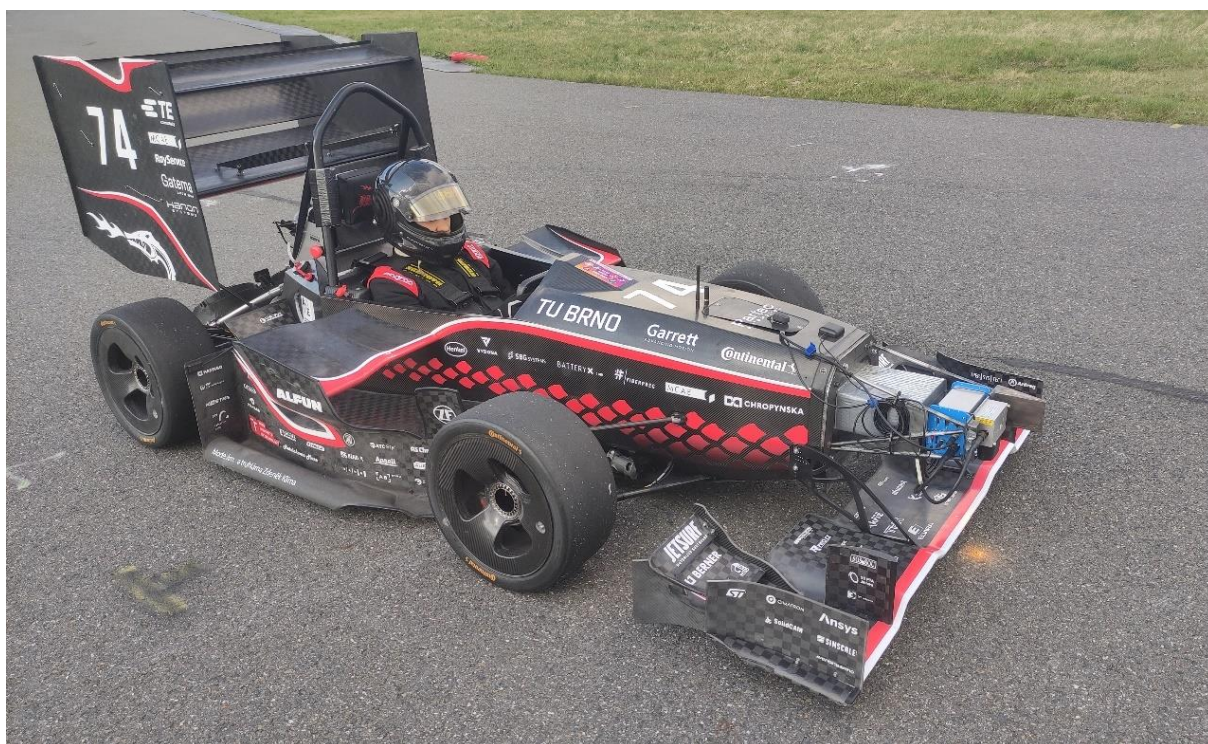
Obr. 73 Fotografie z testování – umístění optického senzoru Correvit na vozidle Dragon X
