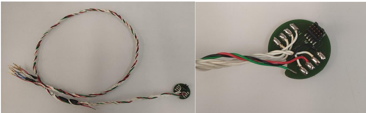
Obr. 33 Výroba kabeláže aktuátoru řízení, vpravo detail DPS pro připojení enkodéru motoru
