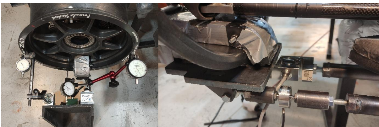
Obr. 58 Vlevo měření deformace nápravy pomocí číselníkových úchylkoměrů ve třech bodech ráfku, vpravo detail zatěžujících tyčí s tenzometry
